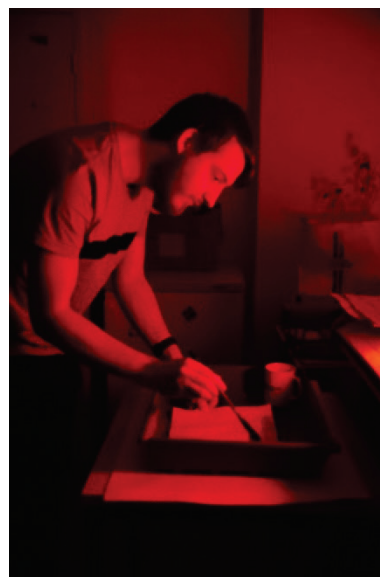
Abb. 3 und 4: Herstellung der benötigten Lösungen und Auftrag der fertigen Emulsion.
