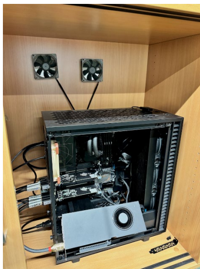
Abb. 3: Umgebauter Aktenschrank mit Aufnahmecomputer, zusätzlicher Kühlung und Anschlusskabeln der volumetrischen Kameras.
