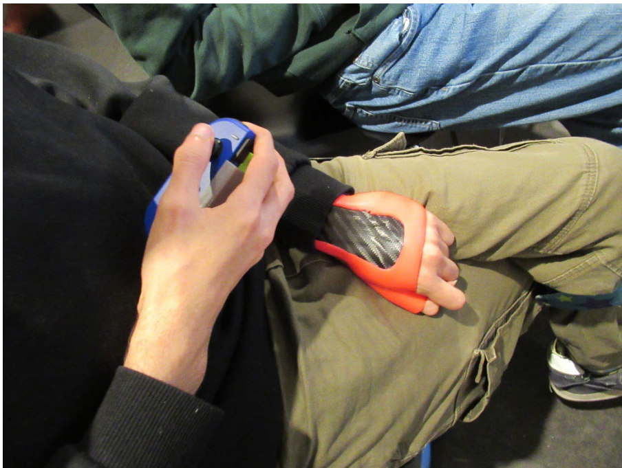
Abb. 4: Die im 3D-Druck hergestellte Ein-Hand-Schiene für die Joy-Cons der Nintendo Switch in action im Zepplab. Foto: Judith Willkomm.
