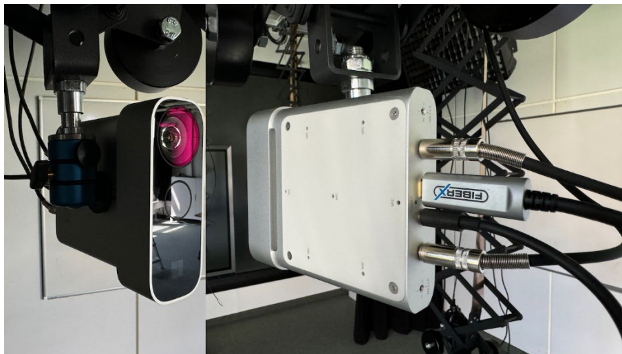
Abb. 4: Microsoft Azure Kinect DK Kameras, die zur Aufnahme der volumetrischen Videos verwendet werden. Links: Vorderseite. Rechts: Rückseite mit Synchronisations-Kabeln (oberes und unteres Kabel), USB-C-Kabel und Stromkabel (schwarz).
